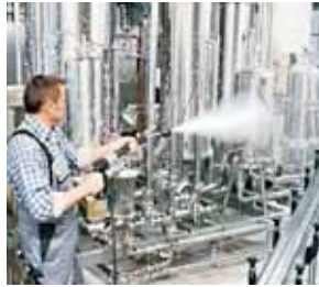
Las plantas embotelladoras se limpian rápidamente con ayuda del sistema Inno Foam.
